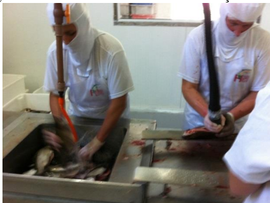
Figura 9. Evisceradora automatizada e lavção da truta.
