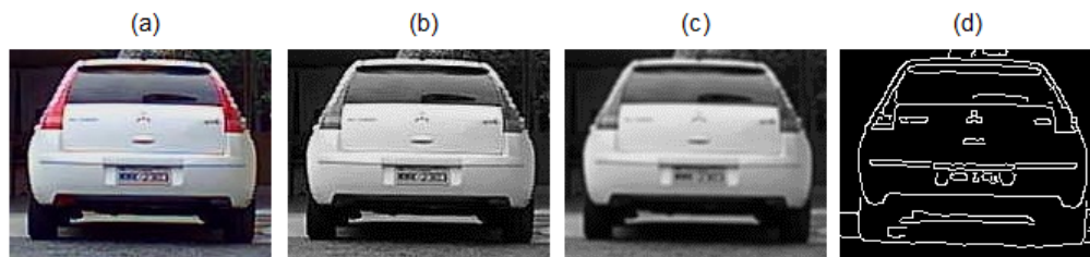
Figura 51 – Imagens: (a) Original. (b) Tons de cinza. (c) Suavizada. (d) Binária
