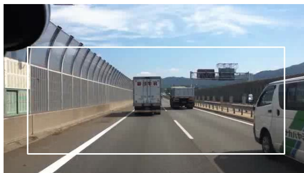
Figura 60 – Retângulo (branco) representando a ROI para detecção de veículos
