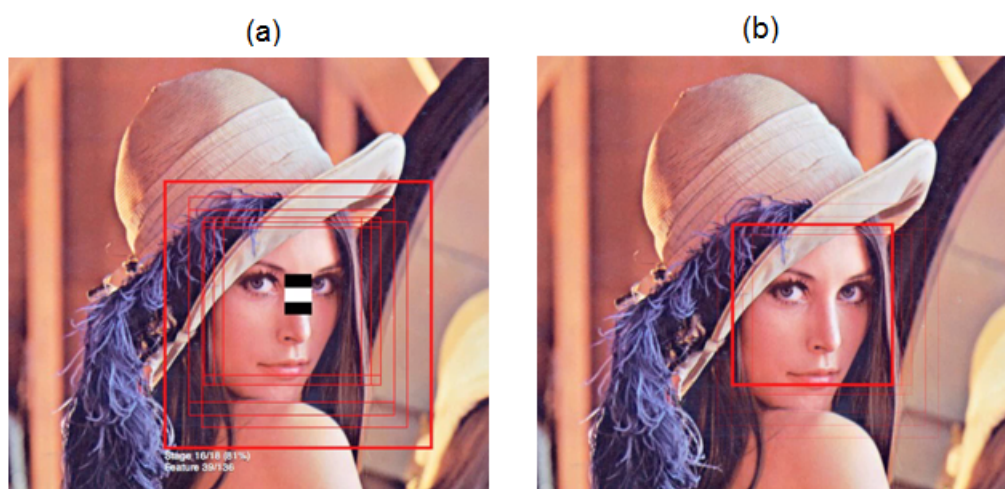
Figura 26 – Sub-janelas de detecção em escalas diferentes. (a) Várias sub-janelas em escalas diferentes para a mesma face. (b) Sub-janelas combinadas em apenas uma área de detecção
