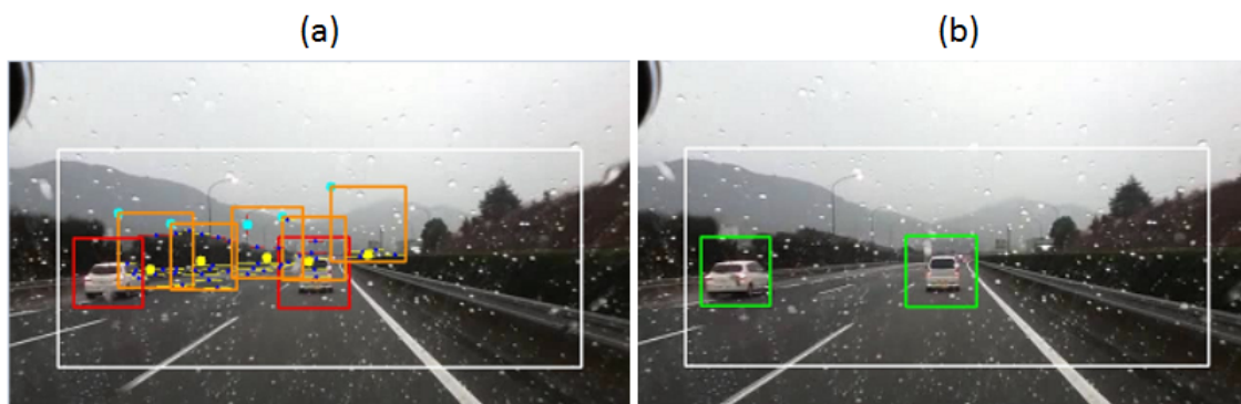
Figura 66 – (a) Quadro Q_t com detecção e VH. (b) Quadro Q_{t+1} rastreando apenas as regiões validadas em Q_t
