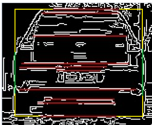
Figura 71 – Identificação da caixa delimitadora do veículo utilizando a técnica CCLVH
