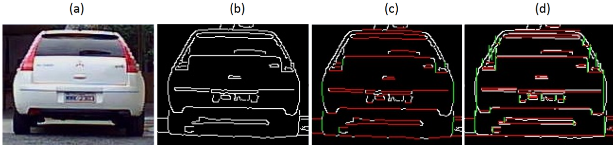
Figura 53 – (a) Imagem original. (b) Detecção de bordas de Canny. (c) Linhas verticais e horizontais detectadas com MaxGap = 0. (d) Linhas verticais e horizontais detectadas com MaxGap = 3.
