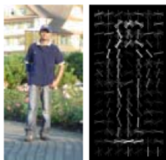
Figura 2.2: Exemplo de imagem 64x128 do conjunto de treinamento e a representação do descritor HOG resultante do treinamento.
