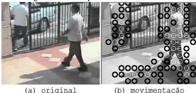
Figura 29 – Imagem destacando pontos de borda x interior
