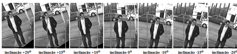
Figura 35 – Influência da inclinação da câmera na detecção HOG
