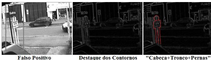
Figura 36 – Exemplo de detecção falso-positiva de objeto estático
