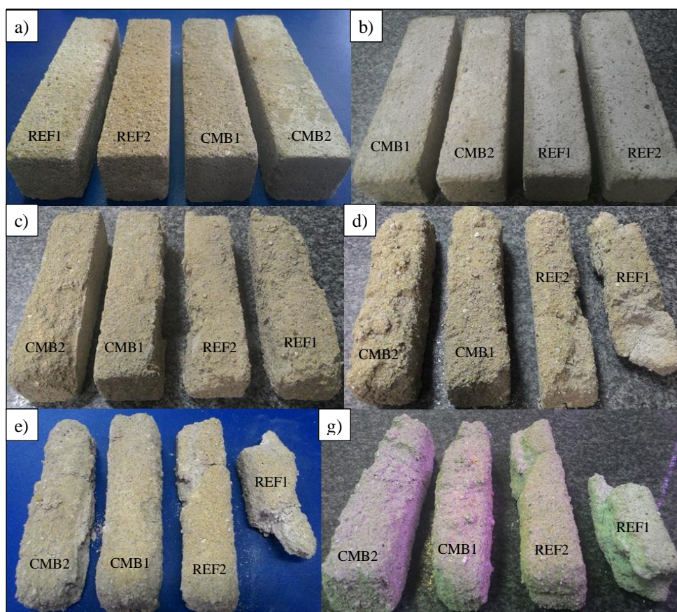
Figura 53 - Aspecto dos corpos de prova após (a) 6, (b) 10, (c) 15, (d) 21, (e) 25 e (f) 31 ciclos de molhagem e secagem
