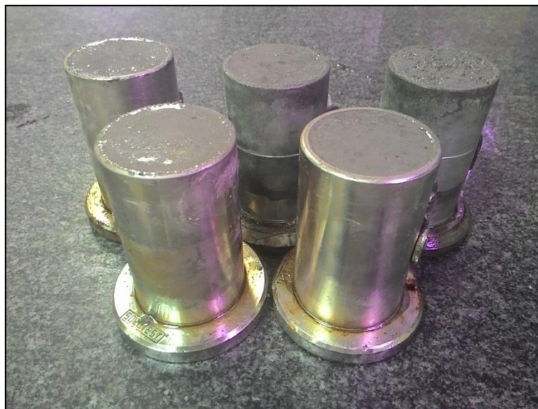
Figura 13 - Corpos de prova para atividade pozzolânica
