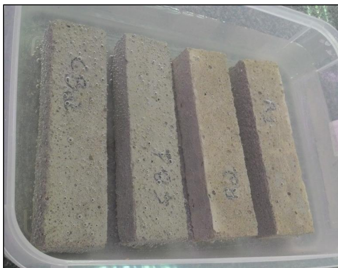
Figura 22 - Amostras imersas em solução de sulfato de sódio
