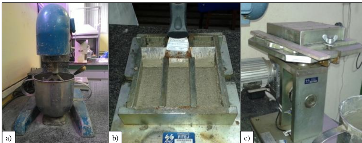
Figura 14 - Preparação da argamassa e moldagem dos corpos de prova, (a) misturador mecânico, (b) nivelamento da argamassa no molde, (c) mesa de adensamento por queda
