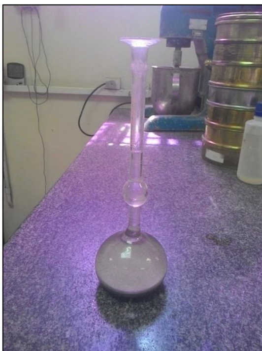
Figura 12 - Deslocamento do líquido no frasco Le Chatelier
