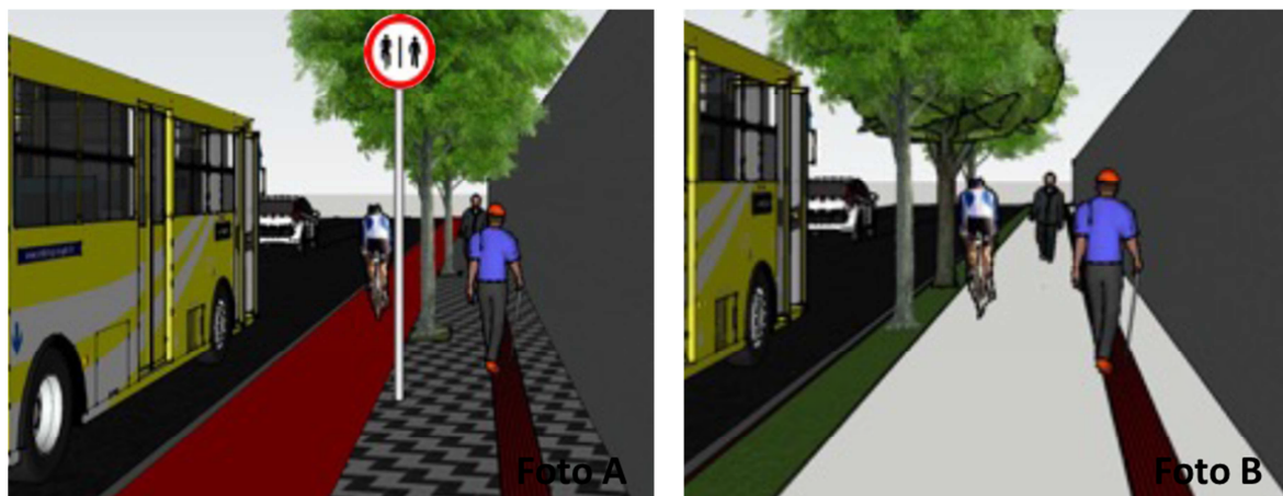
Figura 03 - Modelo de calçadas A) modelo de calçada partilhada e B) modelo de calçada compartilhada.
