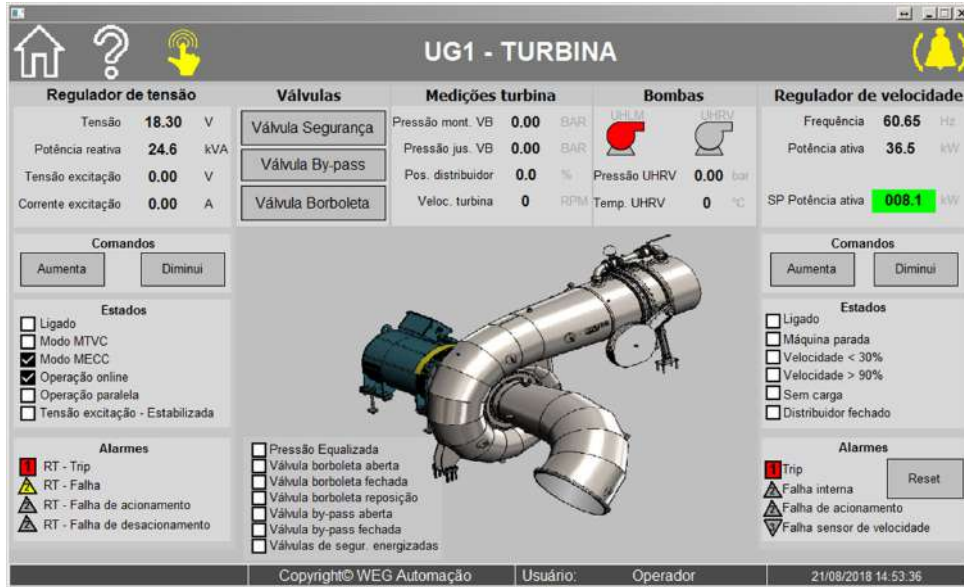
Figura 12 – Sistema SCADA para planta de hidrogeração.
