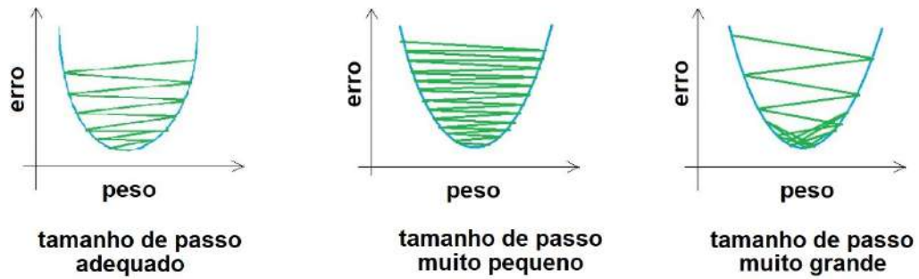
Figura 65 – Gradiente descendente e minimização do erro.
