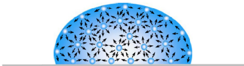
Figura 2.9: A tensão superficial é causada pelo desequilíbrio das forças de moléculas líquidas na superfície.
