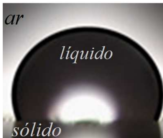
Figura 4 – Visão de perfil da gota de água sobre a superfície rugosa [13].
