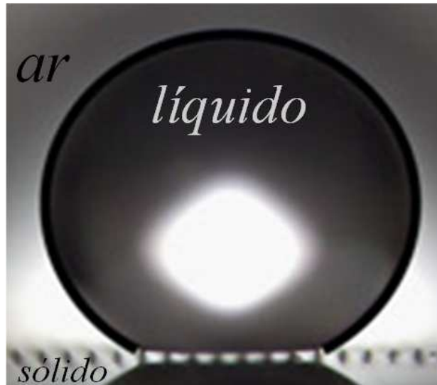
Figura 6 – Visão de perfil da gota de água sobre a superfície rugosa. A gota de água esta sobre uma superfície rugosa e nesta superfície aparecem bolsões de ar entre o sólido e o líquido [13].
