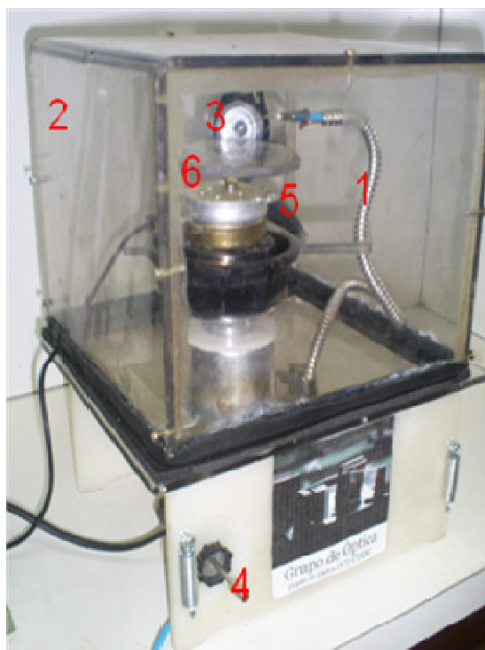
Figura 12 – SMAC usado para análise do ângulo de contato aparente.
