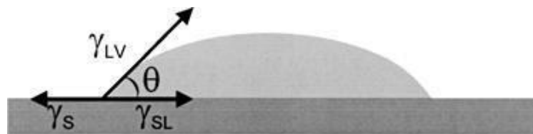
Figura 6: Relação entre o ângulo de contato e as tensões superficiais encontradas na equação de Young.
