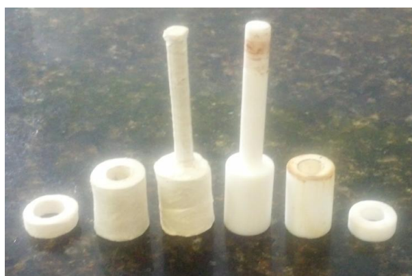
Figura 3.2: Suportes de cerâmica à esquerda e de teflon à direita.
