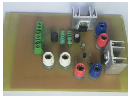
Fig.2 Conversor CC-CC Buck confeccionado
