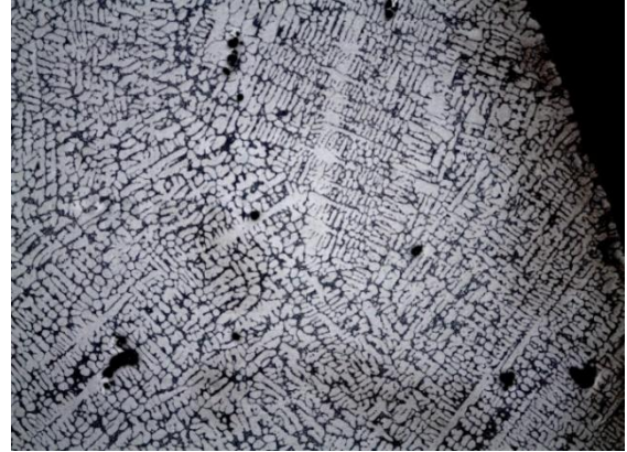
Fig. 1: Imagens óticas que mostram o efeito da extração de calor do corpo de 18 mm, bruto sem adição de titânio, (a) Região central e (b) Região da extremidade.
