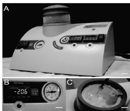
Figura 9. Equipamento comercial Vit-IMT usado na vitrificação
