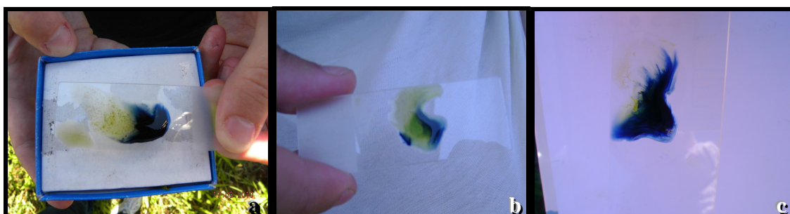
Figura 6 - Teste da Difenilamina. Reações positivas. a. Amostras de pastagens coletadas no município de Faxinal dos Guedes-SC. b. e c. Amostras de pastagens coletadas no município de Seara-SC.
