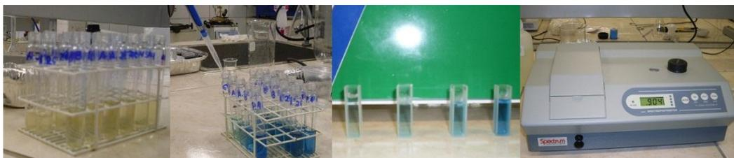
Figura 22 – Processos do método colorimétrico descrito por Weatherburn para determinação de N-NH<sub>3</sub>.
