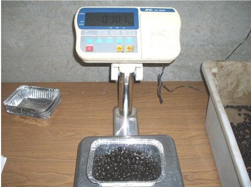
Figura 16 – Pesagem da amostra e bandeja.
