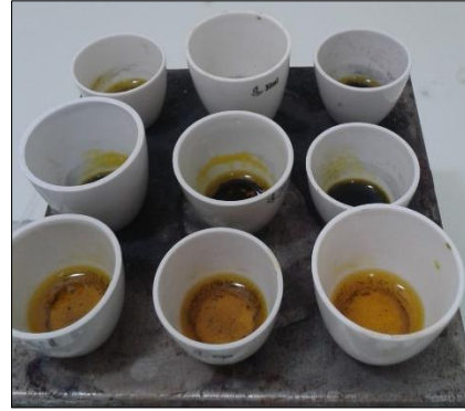
Digestão de amostras em placa aquecedora
