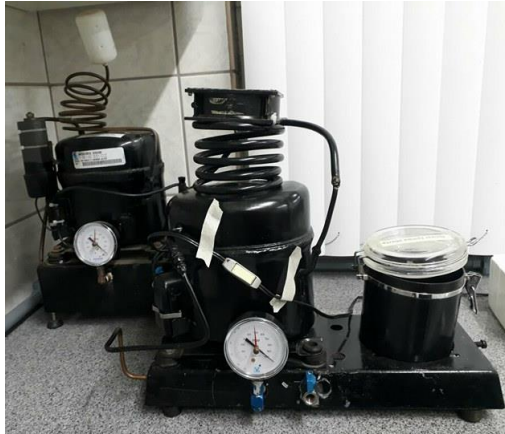
Figura 1 - Protótipos do “Nitrocooler”, ambos em versão com controle de pressão através da adaptação de um barômetro acoplado em seu sistema de sucção.
