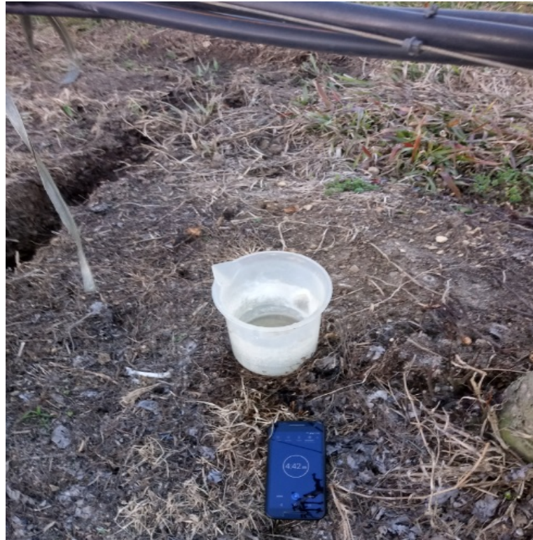
Figura 5 - Teste de uniformidade de vazão dos gotejadores para determinação de eficiência de desempenho do sistema de irrigação. CAV/UEDESC, Lages (SC), 2019
