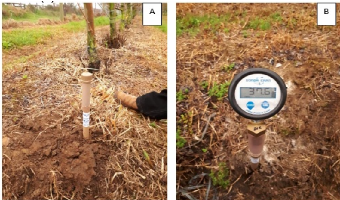
Figura 6 - Tensiômetro instalado no solo (A) e monitoramento hídrico através de tensímetro (B). CAV/UEDESC, Lages (SC), 2019
