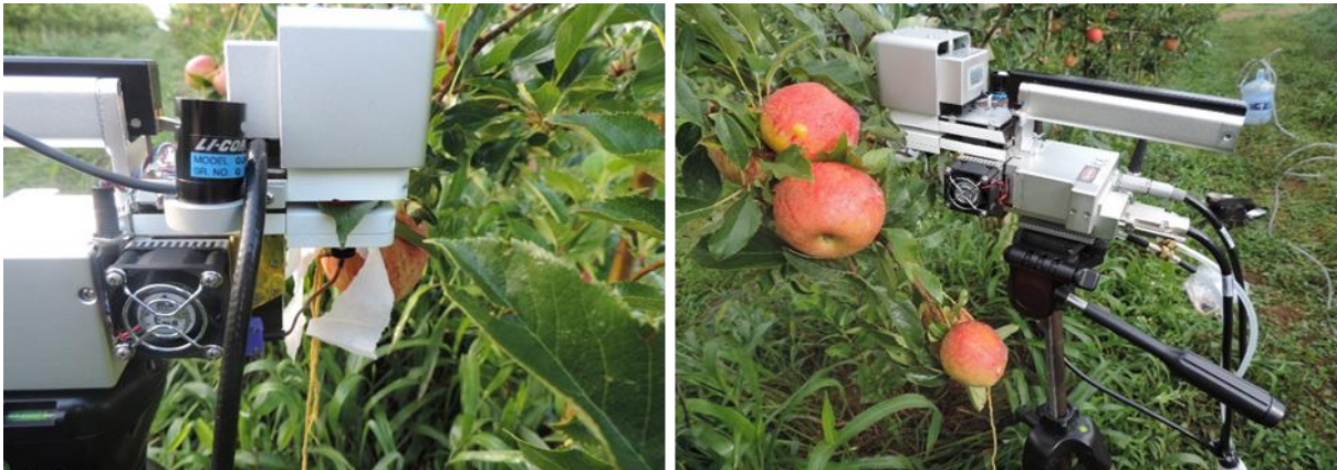
Figura 3- Determinação das curvas de assimilação de \text{CO}_2 nas folhas de macieiras 'Maxi Gala' em resposta ao aumento na densidade de fluxo de fótons fotossinteticamente ativos (DFFFA) com analisador de gás infravermelho (IRGA). Monte Alegre dos Campos, RS, 2017.
