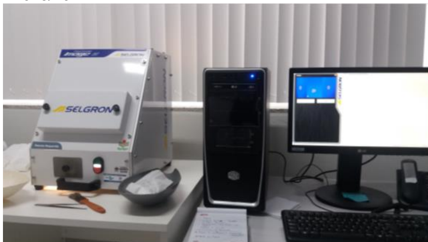
Figura 6 – IMAGE Rice Grain Scanner (Selgron), utilizado para avaliação da qualidade de grãos. Epagri – Estação Experimental de Itajaí, 2016/2017.
