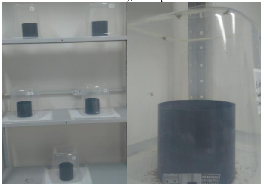
Figura 5 - Tubos cilíndricos de plástico preto utilizados para realizar a seleção de fenótipos superiores para a capacidade de voo em condições de laboratório ( 25 \pm 2^\circ\text{C} , UR 60 \pm 10\% e fotofase 14 horas), Embrapa Uva e Vinho Vacaria- RS, 2019.
