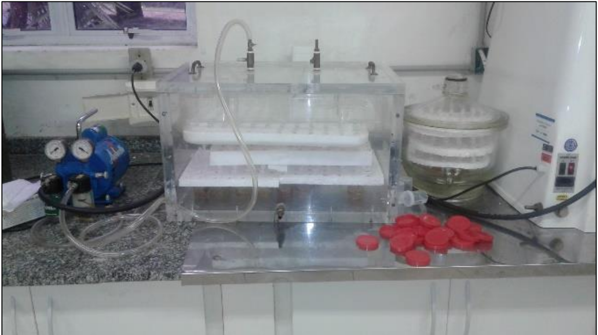
Figura 2 – Câmaras de vácuo utilizadas durante exposição a solução conservadora FAA e as fases de desidratação etílica, pré-infiltração e infiltração de historesina.
