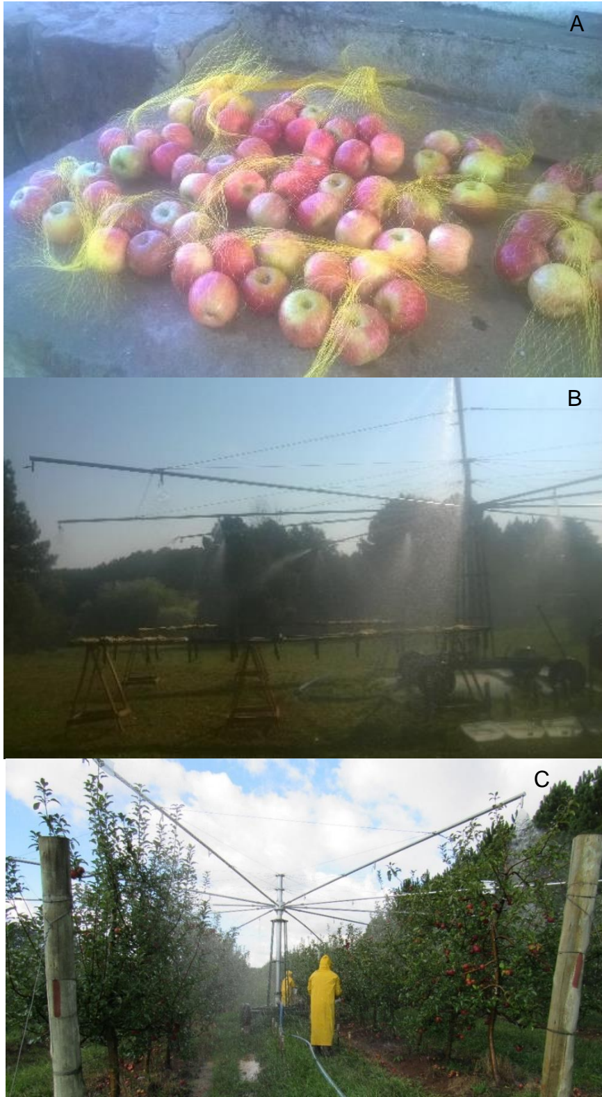
Figura 1: Frutos em sacos de rede para aplicação perfeita (mergulho na calda) (A). Chuva simulada sobre as bancadas com frutos da aplicação perfeita (B). Chuva simulada nas plantas de macieira pulverizadas no campo (C).
