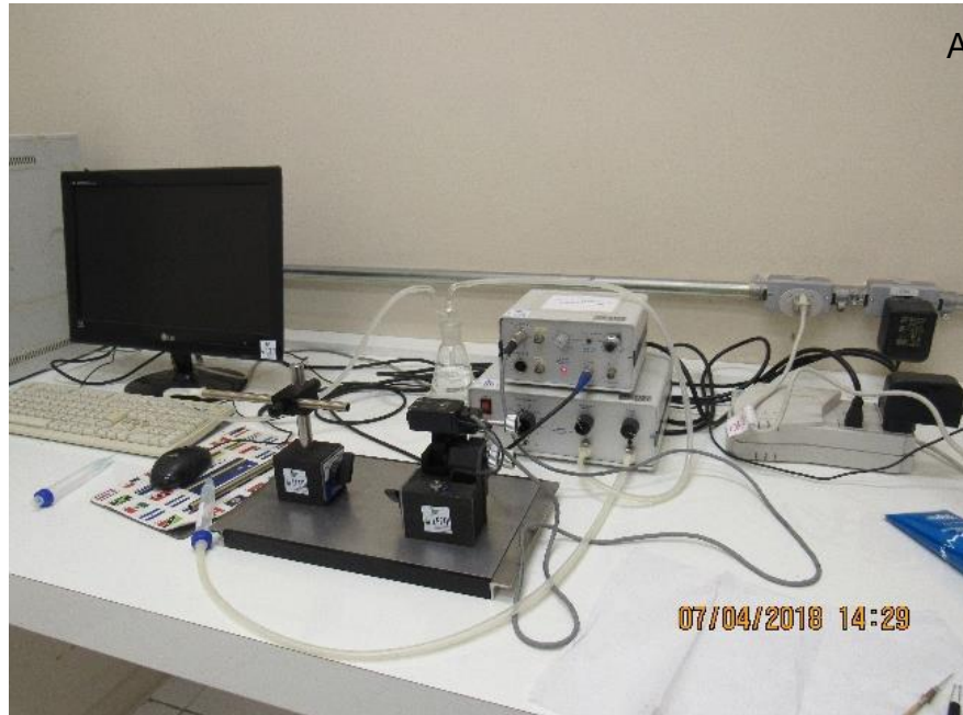
Figura 2: Vista geral do Eletroantenógrafo (A). Detalhe da antena de G. molesta posicionada no eletrodo para realização do Eletroantenograma (B).
