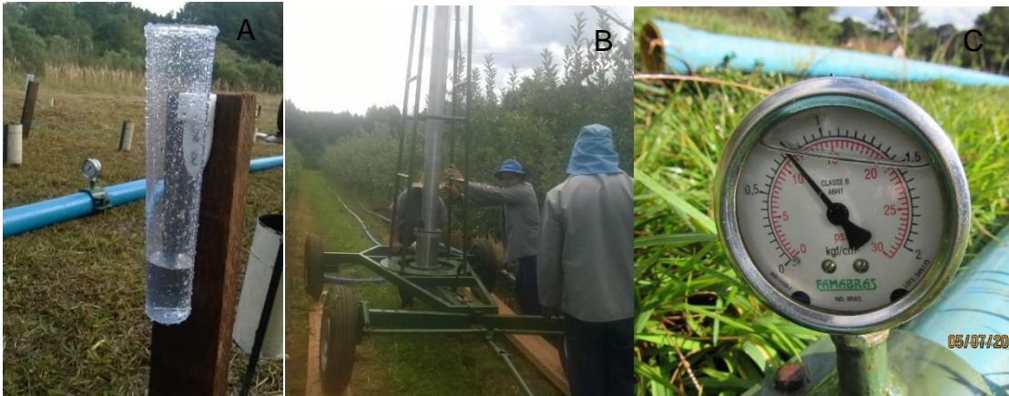
Figura 3: Pluviômetro utilizado para leitura de intensidade de chuva (A), Simulador de chuva nivelado com pranchas de madeira (B), Manômetro para verificação da pressão do sistema (C).
