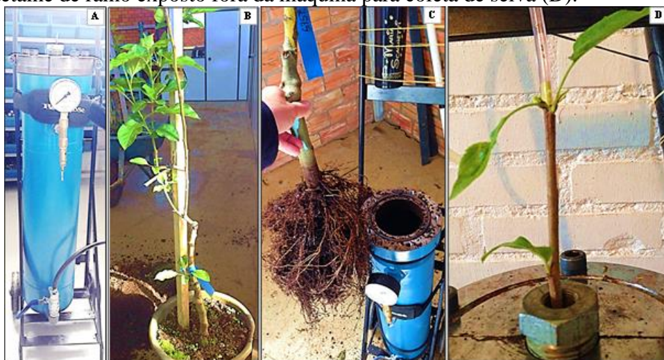
Figura 6 - Protótipo construído para extração de seiva de plantas (A), planta de macieira acondicionada em vaso (B), planta sendo acondicionada dentro da máquina (C) e detalhe de ramo exposto fora da máquina para coleta de seiva (D).
