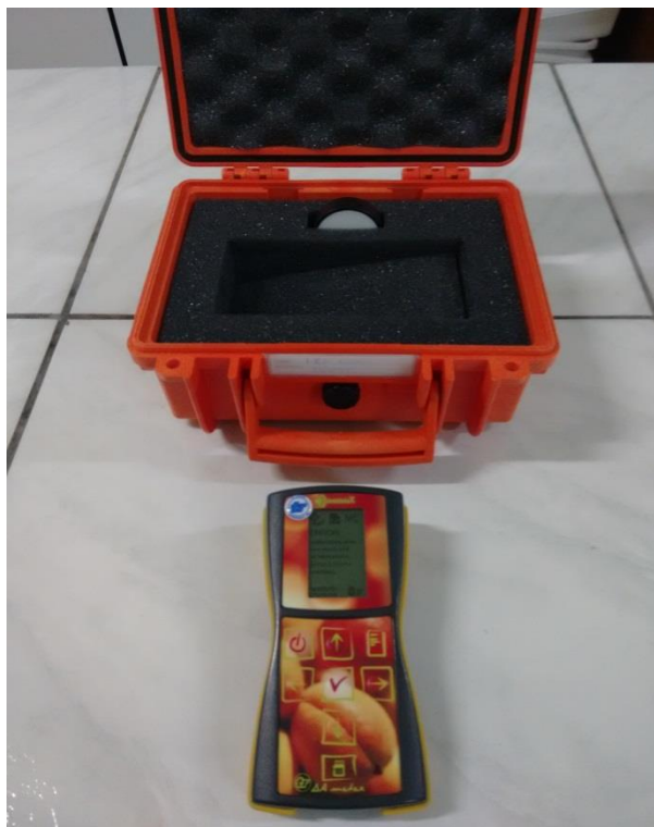
Figura 3 - Aparelho DA-Meter, utilizado para a leitura do índice do teor de clorofila na epiderme de frutos, através do índice de diferença de absorbância (IDA).
