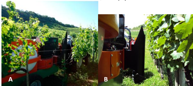
Figura 3 - Aplicação do Fluxo de Ar Quente pela Thermal Pest Control (A). Detalhe do difusor de ar na aplicação do Fluxo de Ar Quente sobre o vinhedo comercial em Pinto Bandeira, RS (B).
