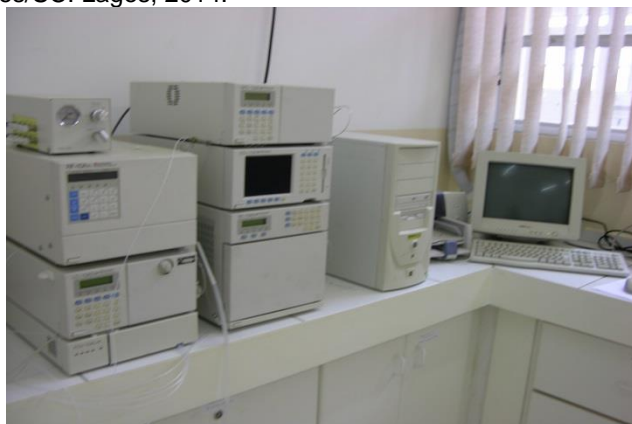
Figura 11. Cromatógrafo modelo LC – 10AD VP, da marca Shimadzu, instalado no Laboratório de Análises de Alimentos do Centro de Ciências Agroveterinárias da Universidade do Estado de Santa Catarina em Lages/SC. Lages, 2014.
