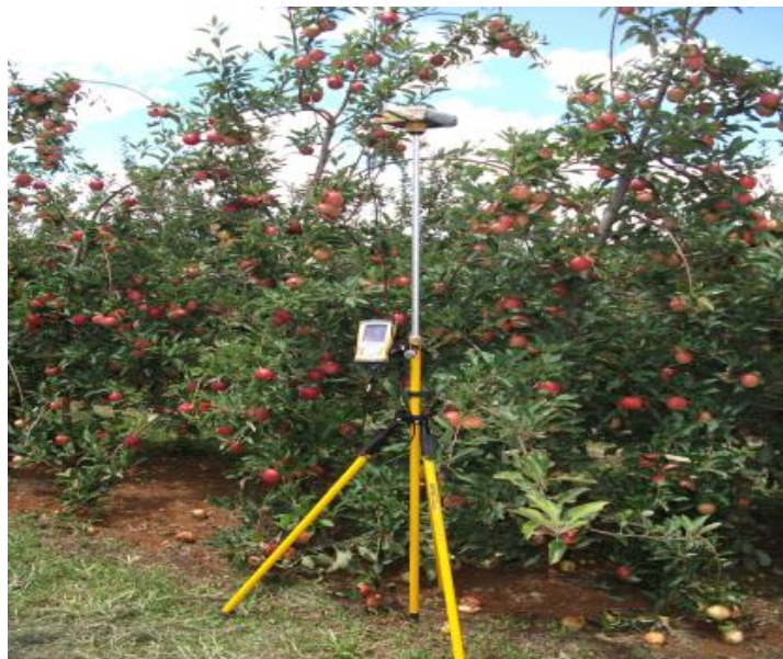
Figura 6- GPS móvel (rover) para georreferenciar as plantas (amostras), Vacaria 2011.
