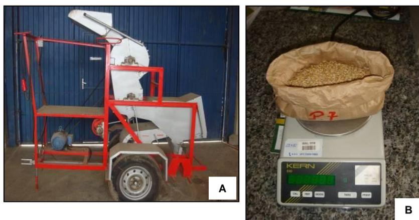
Figura 20. Máquina estacionária utilizada para o processo de trilha e limpeza da cevada (A). Pesagem dos grãos colhidos por parcela em balança analítica (B). Fotos: Agostinetto & Sachs (2010)
