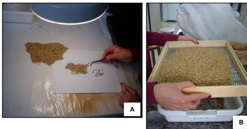
Figura 21. Detalhe da quantificação da massa de mil grãos (A). Detalhe da determinação da granulometria em peneira de malha de 2,5 mm (B). Fotos: Agostinetto & Sachs (2010)
