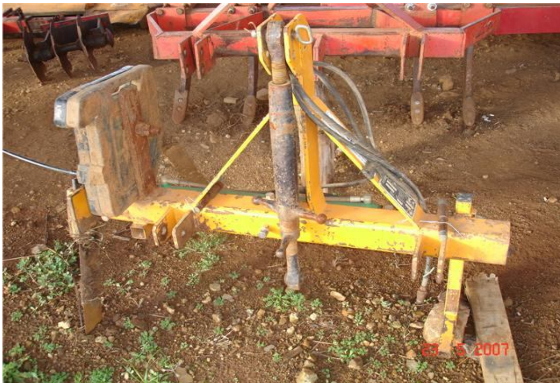
Figura 02 – Implemento usado para efetuar a poda radicular em pêras cv. Abbé Fetel, na Empresa Frutirol, Vacaria, RS, 2007.
