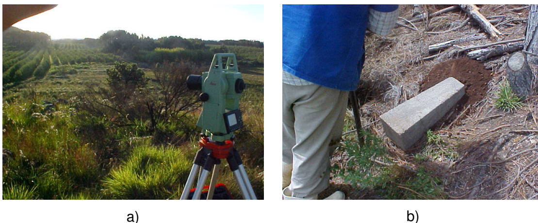
Figura 9 - a) Estação Total sobre um marco visando o pomar; b) implantação de marco de concreto.
