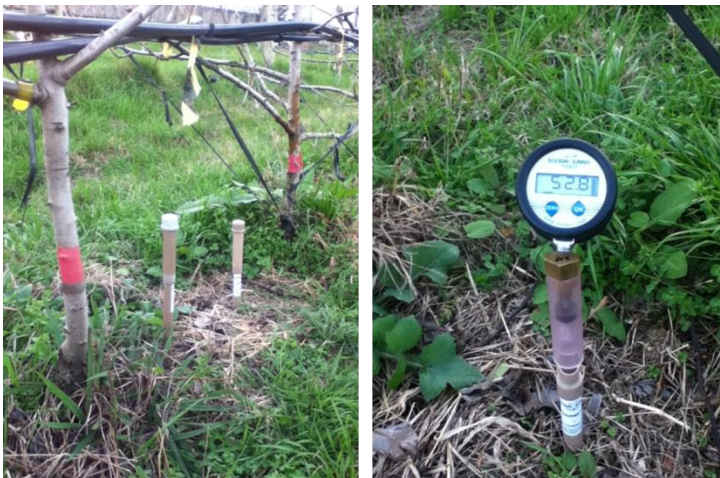
Figura 4 - Tensiômetros instalados no solo e monitoramento hídrico através de tensímetro digital.
