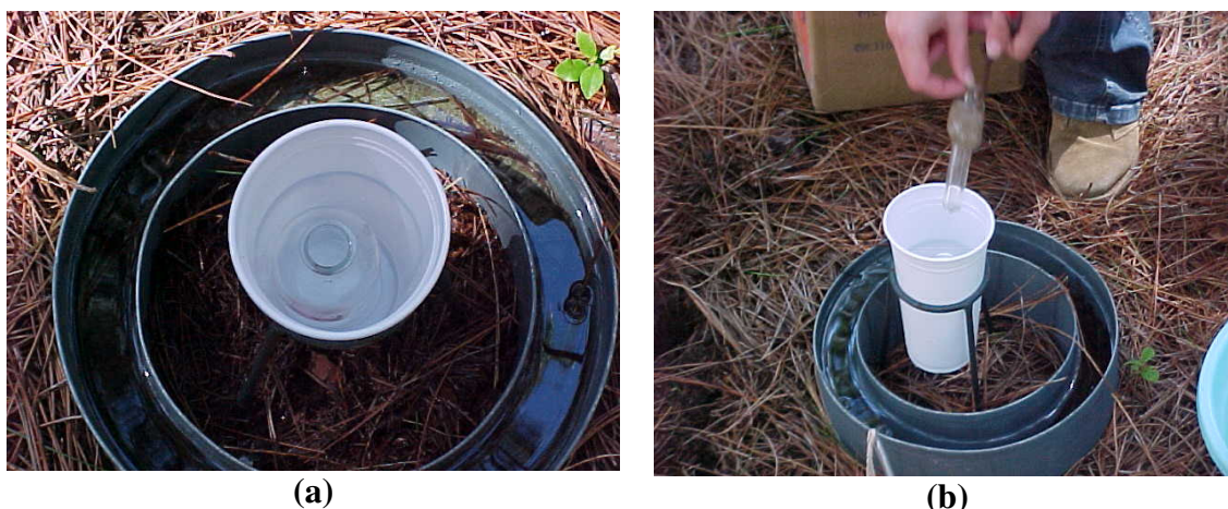
Figura 5 - Detalhe das armadilhas utilizadas para determinação da respiração do solo à campo; (a) calha contendo água na canaleta, copo plástico e frasco com solução de NaOH 0,5 M no seu interior. (b) colocação da solução de BaCl 2 , 24 horas após a montagem das armadilhas.
