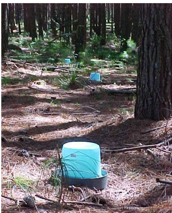
Figura 4 - Detalhe de um transecto de amostragem em área de monocultivo de Pinus contendo as armadilhas usadas para determinação da respiração do solo nos pontos de amostragem.
