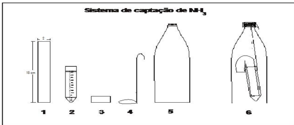
Figura 1 - Material para confecção do sistema de captação de NH 3 . 1. Fita de papel filtro, 2,0 x 18 cm; 2. Tubo plástico de centrífuga de 50 mL, graduado; 3. Tampa da garrafa pet; 4. Suporte de arame; 5. Garrafa pet de 2 L cortada na base; 6. Sistema de captação de amônia montado. A extremidade inferior do papel filtro é mergulhada na solução contida no tubo 2.
