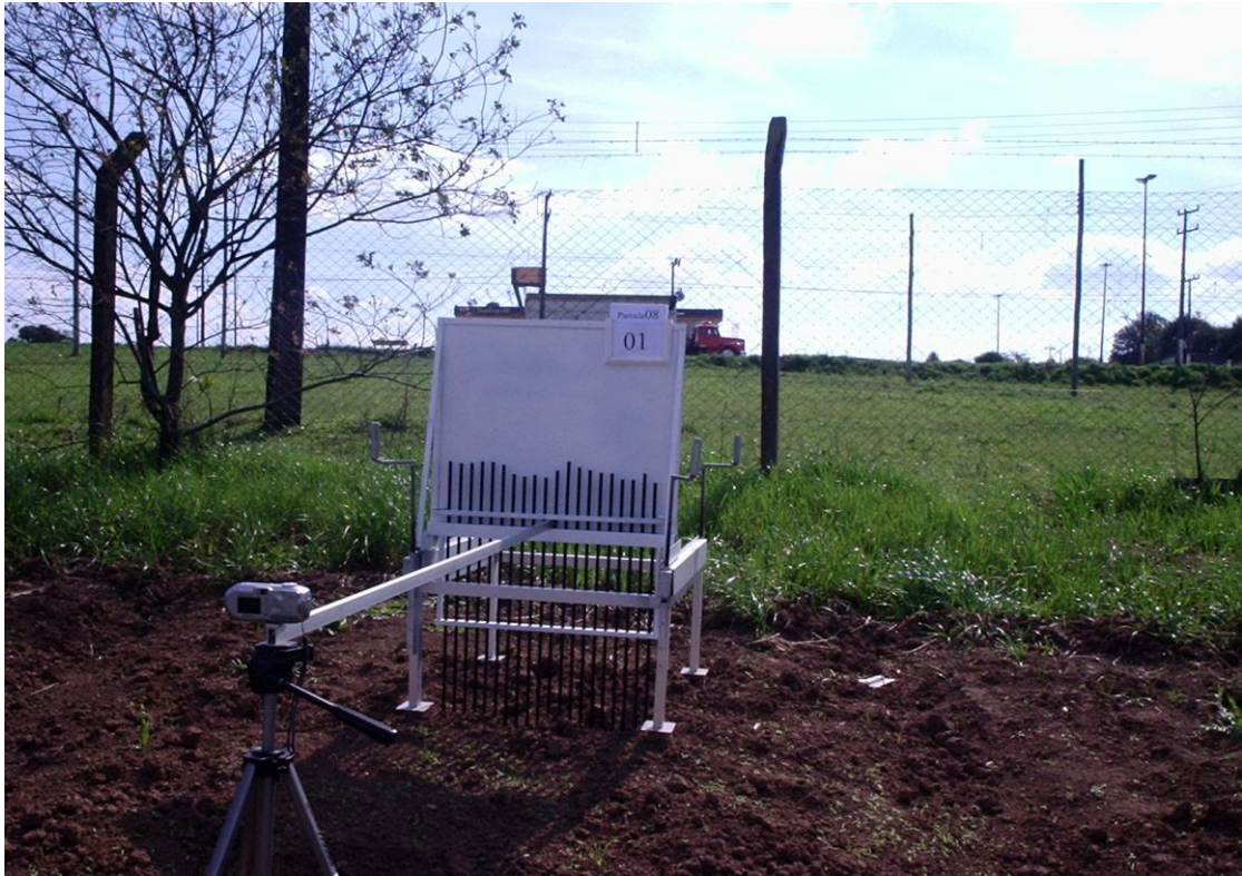
Figura 1. Ilustração do rugosímetro de varetas utilizado no estudo.
