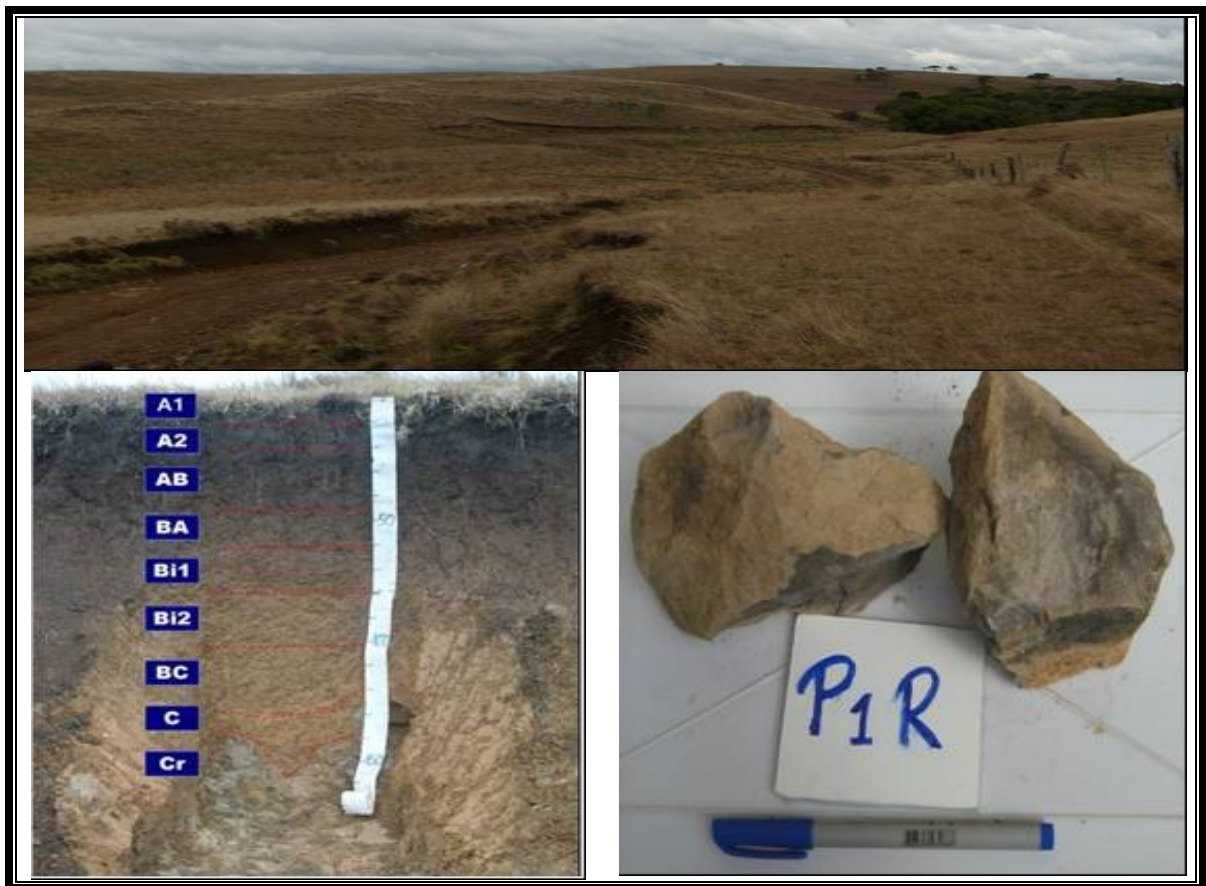
Figura 04 - Perfil 1 Cambissolo Háptico alítico típico. (a) Foto da área; (b) Perfil do solo e; (c) Fragmento rocha subjacente.
