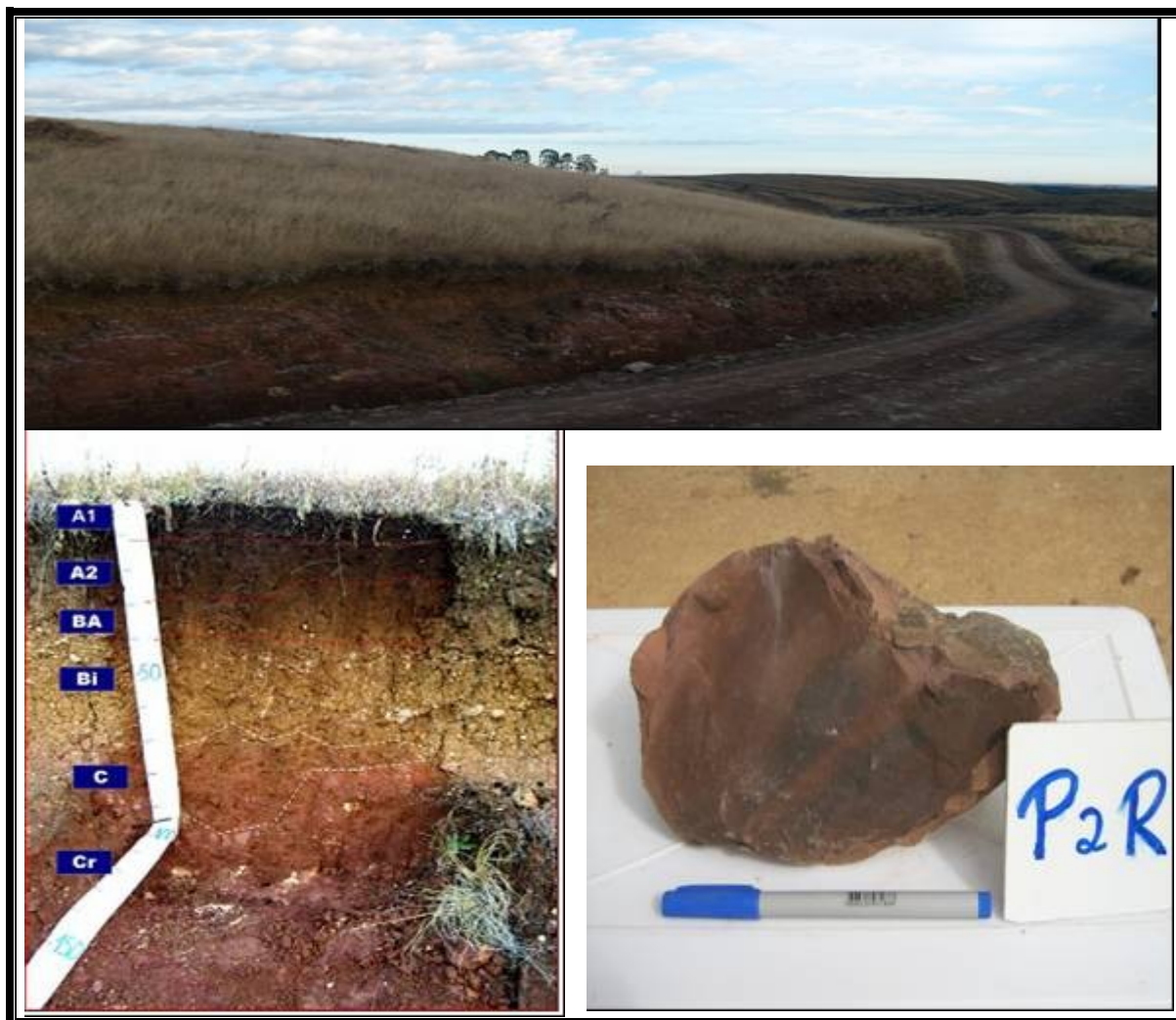
Figura 09 - Perfil 2 Cambissolo Háplico Alumínico úmbrico. (a) Foto da área; (b) Perfil do solo e; (c) Fragmento rocha subjacente.
