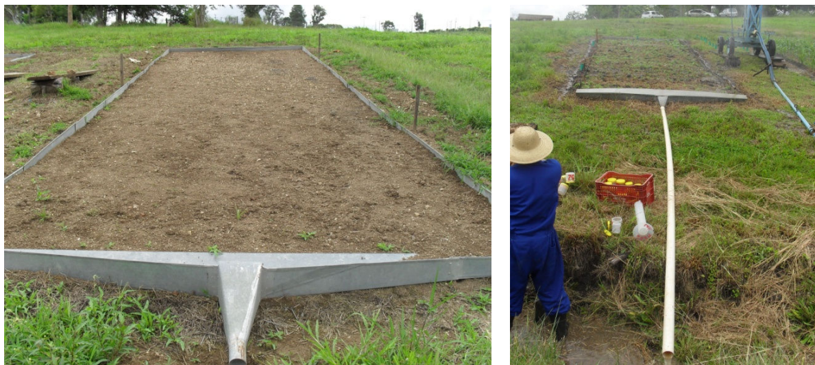
Figura 1 - - Unidade experimental constituída por uma parcela de 38,5 m 2 , delimitada por chapas galvanizadas na extremidade superior e laterais e na parte inferior por uma calha coletora da enxurrada acoplada a um tubo de PVC.
