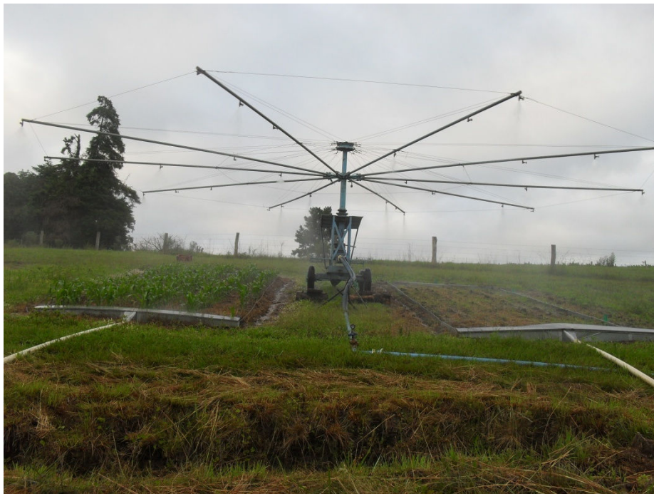
Figura 6 - Aparelho simulador de chuvas de braços rotativos tipo Swanson, com aplicação de chuva sobre duas parcelas simultaneamente.
