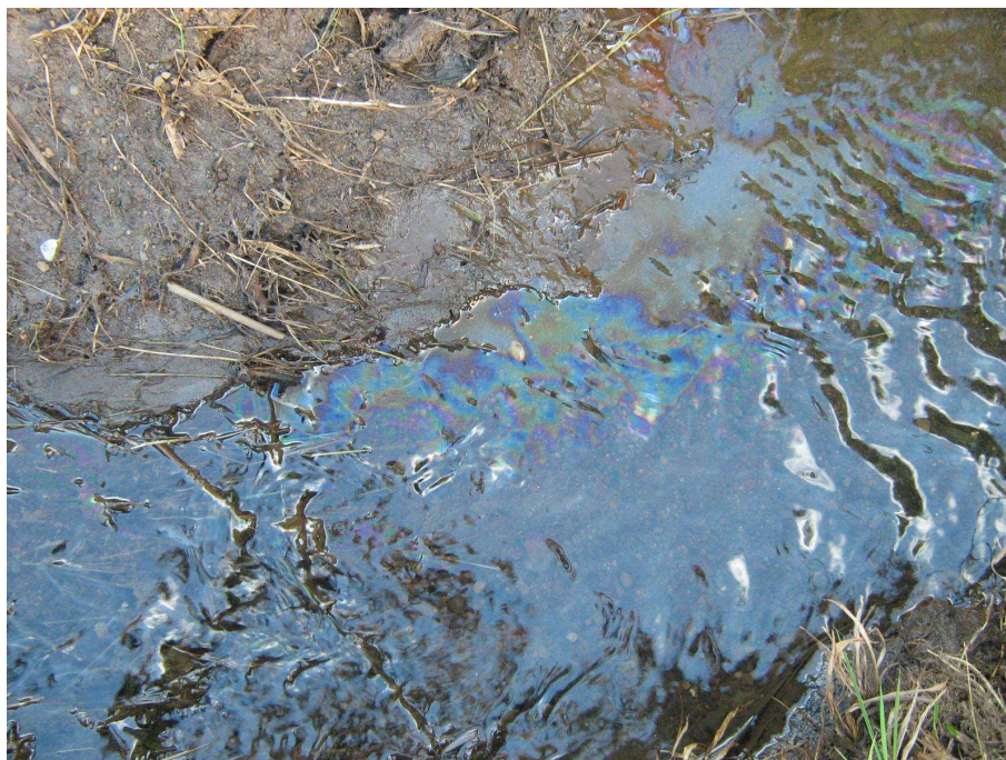
Figura 6 - Vista parcial do combustível escoando superficialmente no solo analisado.
