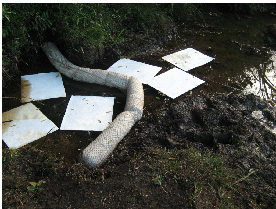
Figura 7 - Vista da contenção física instalada no curso d'água atingido pelo contaminante.
