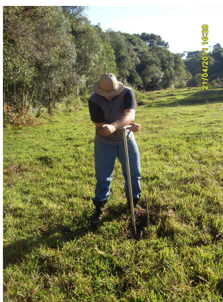
Figura 16 - Coleta de solo, com trado holandês, para análises químicas.
