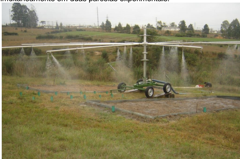
Figura 3 – Aparelho simulador de chuvas com braços rotatórios do tipo empuxo atuando simultaneamente em duas parcelas experimentais.
