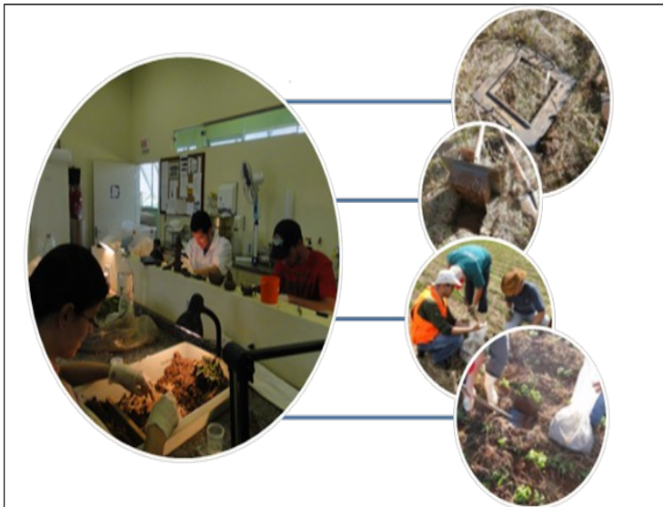
Figura 03 - Detalhe das etapas da coleta de monólitos. 1- Amostrador para TSBF; 2-Retirada do monólito; 3-Coleta da amostra de solo; 4-Ensacando a amostra para ser transportada para o laboratório; 5-Triagem manual com auxílio de iluminação artificial
