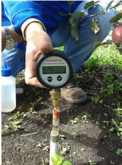
Figura 2- Monitoramento hídrico do solo utilizando tensímetro digital.
