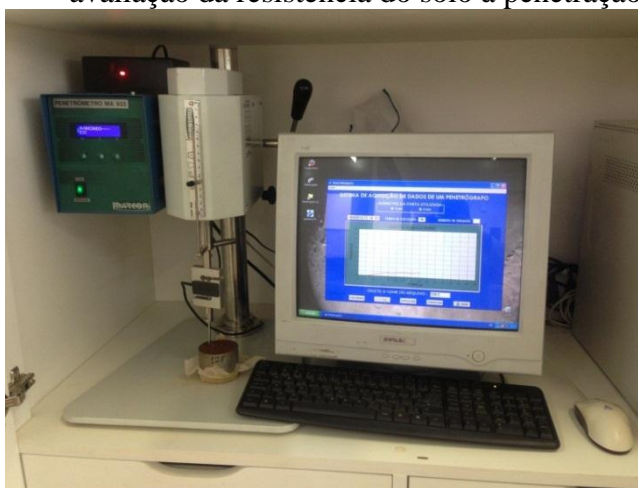
Figura 6 – Penetrômetro estático de bancada utilizado para avaliação da resistência do solo à penetração.
