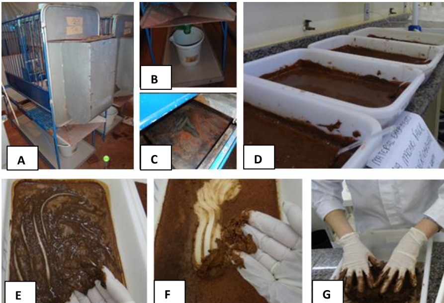
Figura 1 - Vista com detalhes desde a coleta até o modo de preparo dos dejetos de suínos utilizados para os testes ecotoxicológicos. A – Gaiola metabólica. B – Funil para coleta de urina. C – Bandeja para coleta de fezes. D – Pré-secagem dos dejetos nas bandejas. E – Dejetos após três dias de secagem. F – Dejetos após cinco dias de secagem. G – Homogeneização dos dejetos para montagem dos ensaios.
