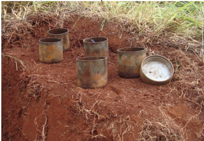
Figura 11 - P7-LB CAS – Latossolo Vermelho distroférico húmico, sem caráter retrátil, localizado do município de Cascavel/PR.
