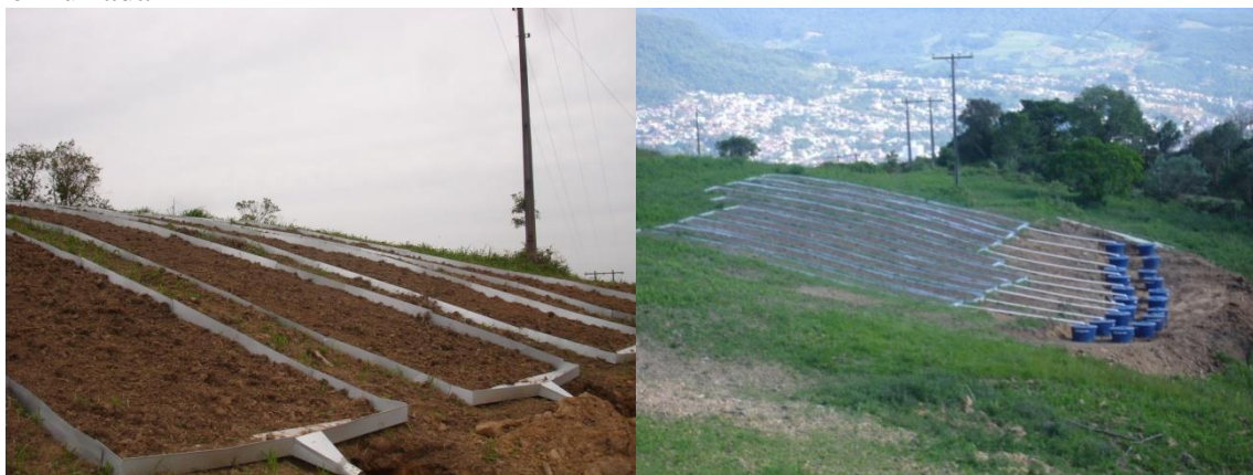
Figura 3 - Parcela, com dimensão de 30 m 2 , e o conjunto das parcelas com tanques coletores de enxurrada
