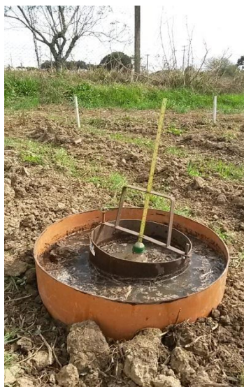
Figura 3 - Imagem dos anéis concêntricos durante teste realizado após a escarificação do solo.
