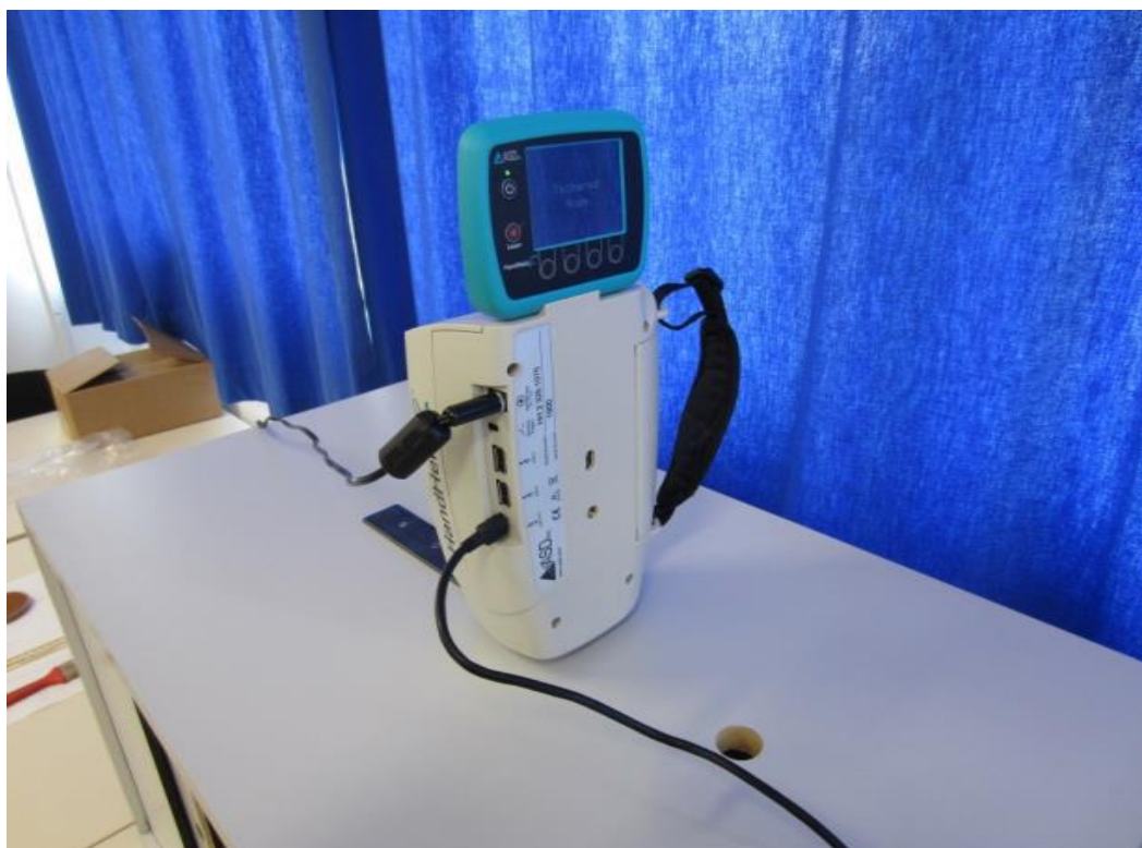
Figura 5 - Espectrorradiômetro FieldSpec HandHeld II (ASD)
