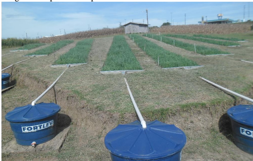
Figura 1: Vista geral das parcelas experimentais e sistema coletor de enxurrada.
