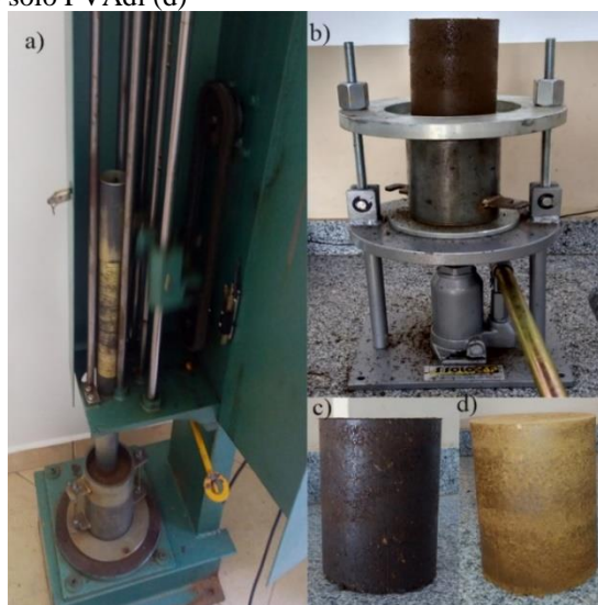
Figura 5 Aparelho (Solotest®) para realização do teste de Proctor (a), extrator de amostra (b), amostra do solo CHd (c) e amostra do solo PVAdI (d)
