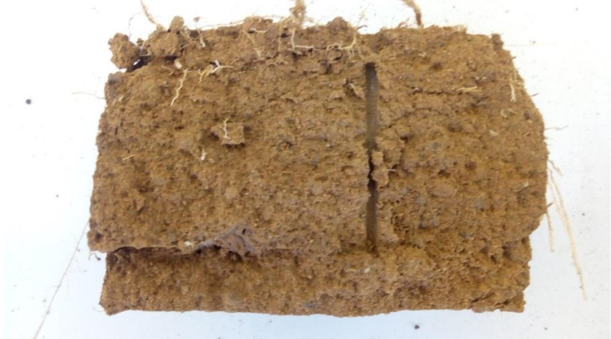
Figura 20 Solo e desenvolvimento de raízes no anel intermediário da coluna do solo Argissolo Vermelho – Amarelo Distrófico latossólico (PVAdl) no grau de compactação de 100%.
